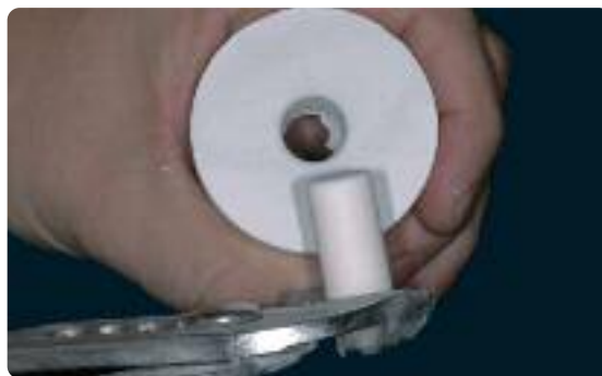
El émbolo Alox ya está muy limpio si se retira con pinzas del material de revestimiento. Revise la limpieza y arene con Al_2O_3 si fuera necesario.
