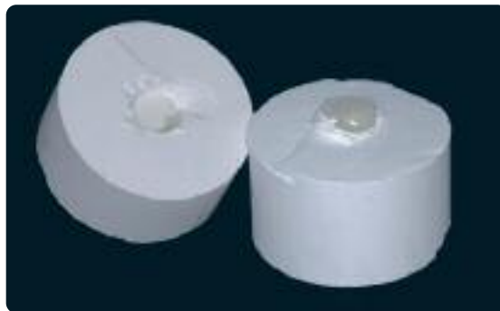
Separe el cilindro de revestimiento con disco de separación
