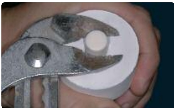
El émbolo Alox ya está muy limpio si se retira con pinzas del material de revestimiento. Revise la limpieza y arene con Al_2O_3 si fuera necesario.
