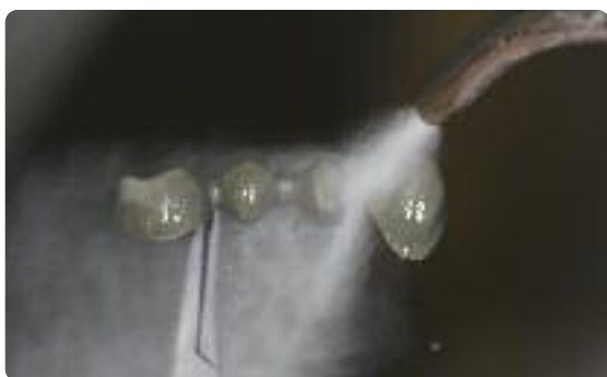
Después del arenado, limpie la estructura de metal con pistola de vapor y déjela secar bien. Realice la cocción de oxidación según las instrucciones del fabricante.
