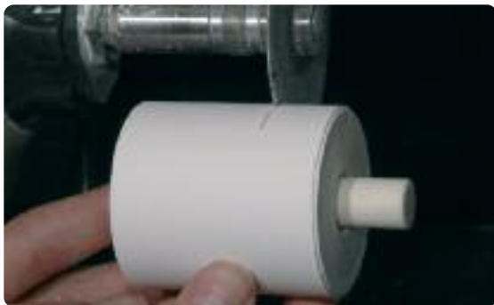
Separe el cilindro de revestimiento con disco de separación
